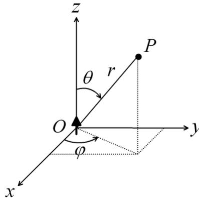
上の図のように微小ダイポールが z 軸に沿って原点に置かれている。長さが波長に比べて十分に短いダイポールアンテナを微小ダイポールアンテナと言い、イメージ的には正と負の電荷を高速に入れ替えて z 方向に振動させているような感じである。電磁界が空間を伝わる速度は無限ではなく、実際には高速 c なので電磁界は波となって空間を伝わっていく。
