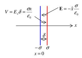
図のような $\pm \sigma$ の面電荷密度、間隔 $\delta$ の電気二重層を考える。 $\sigma\delta$  = const. とした状態で $\delta \to 0$ の極限を取ったときの電界、電位分布を求めると次のグラフのようになる。
