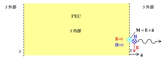
PEC 上の磁流 M で強制的に PEC の境界上で電界の接線成分を作り出す。
