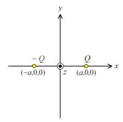
(元のモデルで x<0 の空間に導体があったとしたら、そこの全ての導体は取り除かれて自由空間になっている。ただし、x=0 では電界は x 成分しか持たないので、y-z 面には無限に薄い金属導体があってもよいし、無くてもよい。ただし、今までの知識を使ってフィールドを計算するためには導体を全て取り除いて自由空間にしなければならないから、導体は全て取り除いたと考えて計算を行う)
