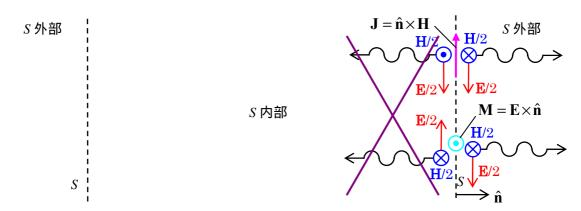
面 S の左側に放射される電磁波は電流  $J = \hat{n} \times H$  と磁流  $M = E \times \hat{n}$  からの放射を足し合わせると 丁度相殺される。つまり、S の外部の電磁界は(S 内の電磁界を考慮しないで)S 上の等価電磁流からの放射によって計算できる。
