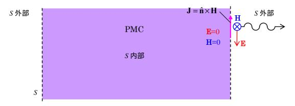
PMC 上の電流 J で強制的に PMC の境界上で磁界の接線成分を作り出す。
