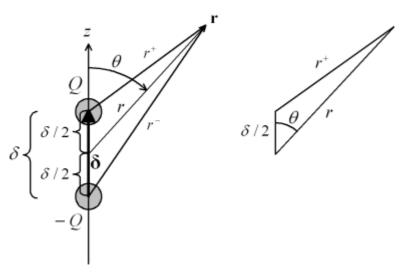
上図のような**電気双極子**(electric dipole)を考える。  $\mathbf{p} = Q \delta$  を**双極子モーメント**(dipole moment) と言う。  $\delta << r$  のとき、上の電気双極子が作るポテンシャルは次のようになる。
