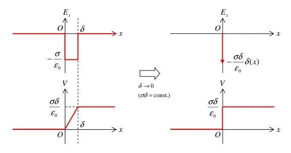
±σの電荷層の間には非常に強い電界がかっており、面の両側では電位が不連続に異なる。
